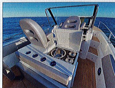
L'assise du siège pilote bascule vers l'avant, dévoilant une petite cuisine constituée d'un évier et de deux réchauds à gaz.
